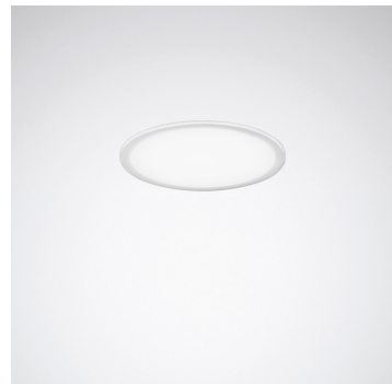
④ Maße (DxH): ca. 235mm*40mm 4000K, 2000lm Ausschnitt D= ca. 215mm
