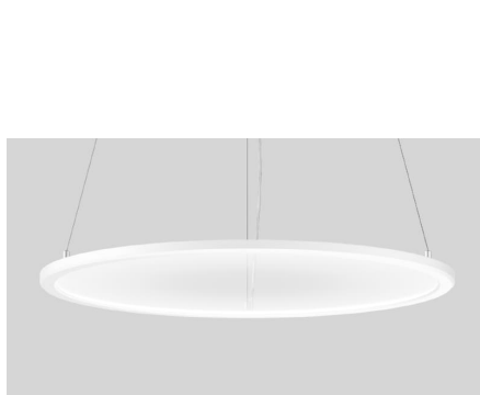
8 Maße (DxH): ca. 600mm*15mm 4000K, 3550lm Pendelleuchte UK = 2550 mm bis 2750 mm OKFFB
