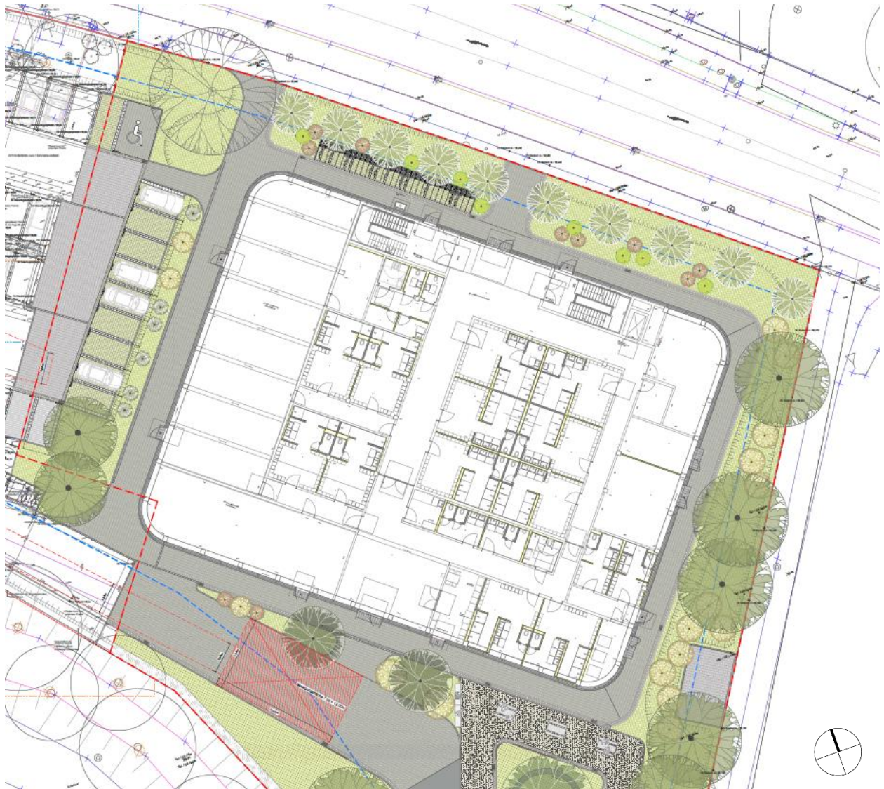
Bild 9: Lageplan der Sporthalle EG für die Variante 02 (einer Verschiebung von rd. 4 m in Richtung Südwest) [U1.19]
