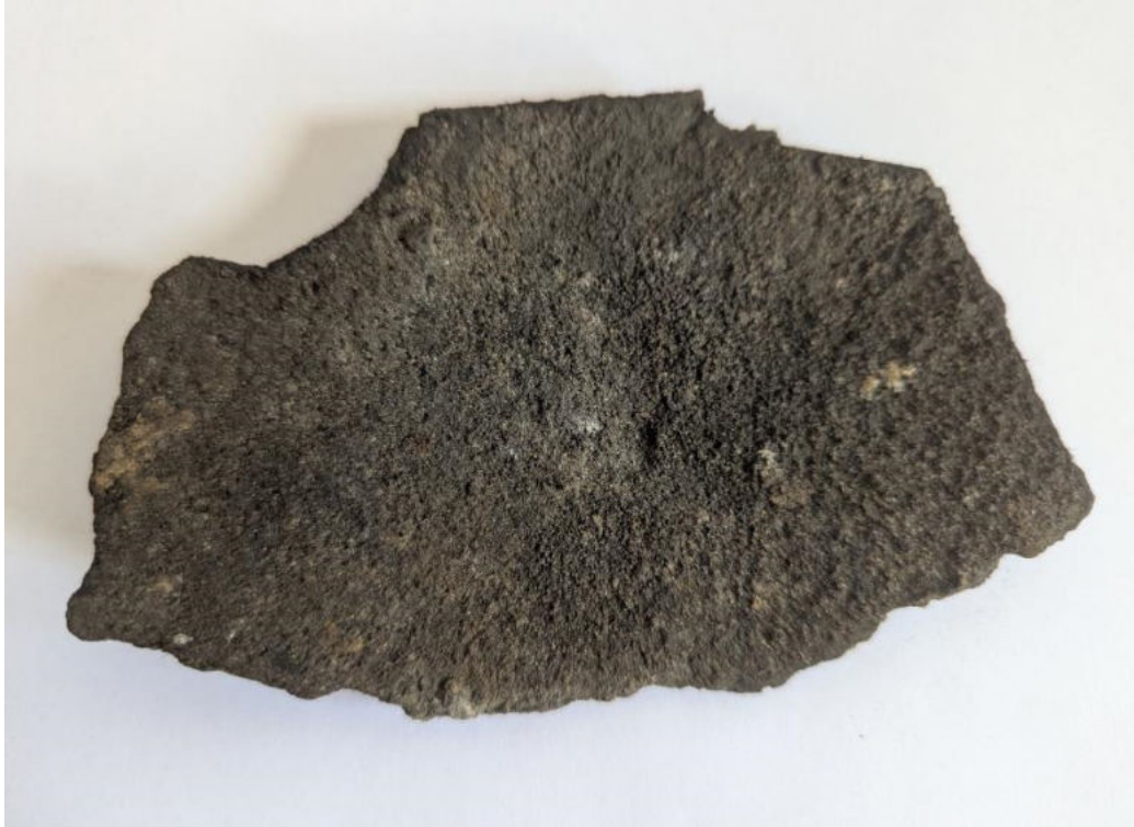
Foto 17: Schurf 5 Materialprobe (kein Asbest)
